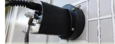
蒸留水を注入し、表面の塩分を攪拌し計測
