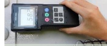
塗膜表面の乱反射の程度を計測
